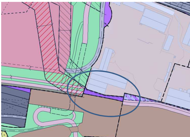
Figur 10: Området hvor sammenkobling mellom regulert sykkelveg med fortau fra Leangen ikke henger sammen med tverrforbindelsen mellom Dalen og Lade.
